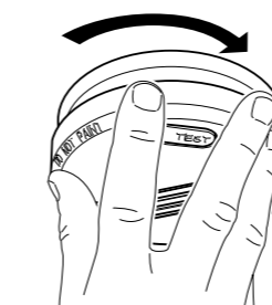
7. Skruva medsols för att sätta fast rökdetektorn i fästet.
